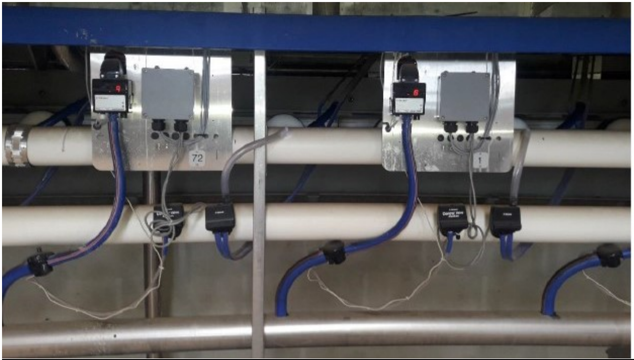
Eksempel 2 på flowmåler til at måle koens ydelse
