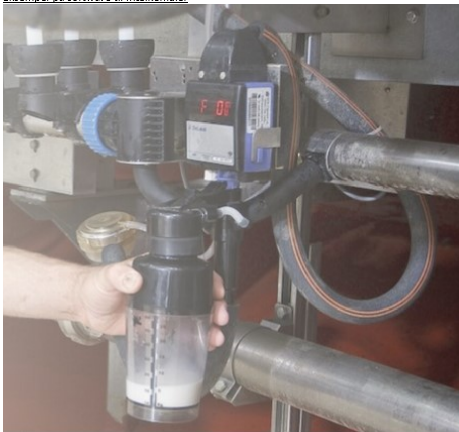
Eksempel 1 på flowmåler til at måle koens ydelse
